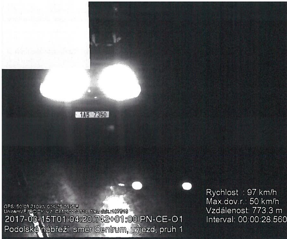
obr. 1 Noční snímek vozidla s vyznačením změřené rychlosti
