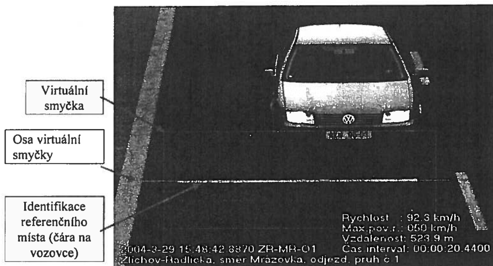
Obr. 7: Virtuální smyčka videodetektoru
