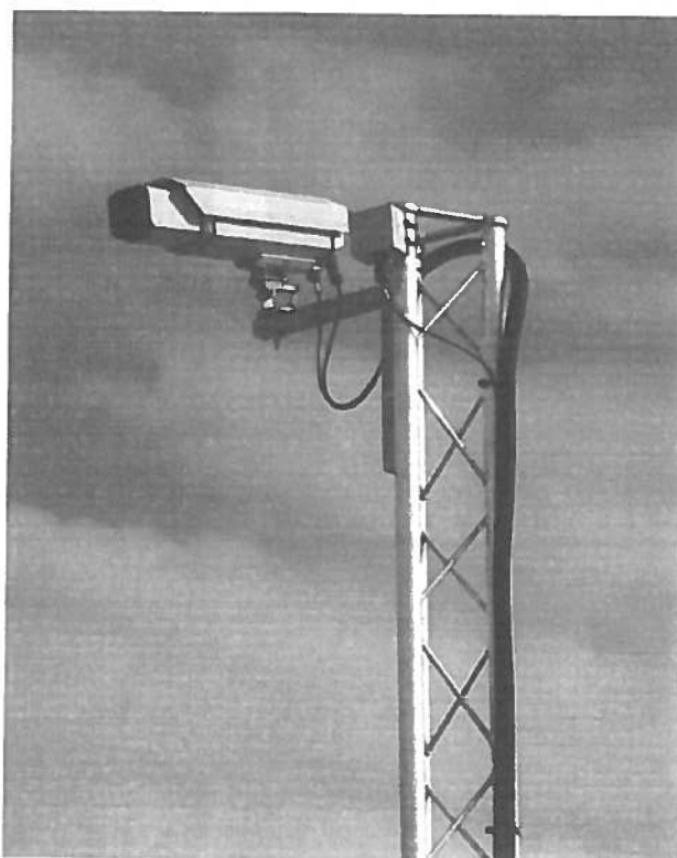
Obr. 11 a 12: Kamerová jednotka UC-D2
