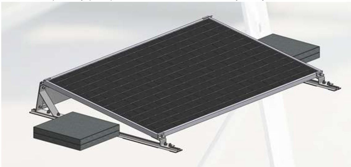
Obr. č. 7.2: Předpokládaný způsob přitížení samonosné konstrukce betonovými bloky
